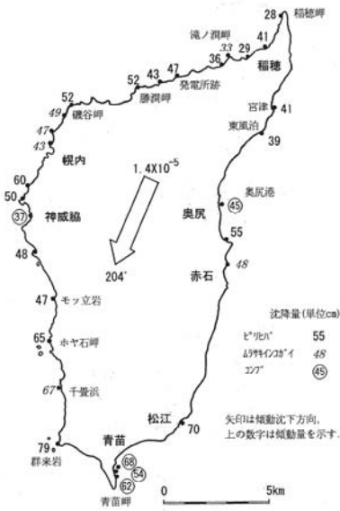
第2図 生物指標から求めた平成5年北海道南西沖地震による地殻変動
