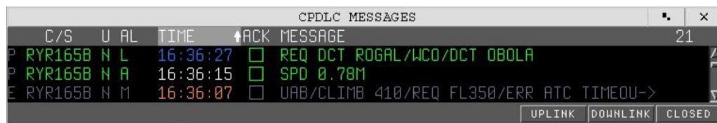
Rys. 4: Okienko wiadomości CPDLC - interfejs po stronie kontrolera. (Źródło: PAŻP)
