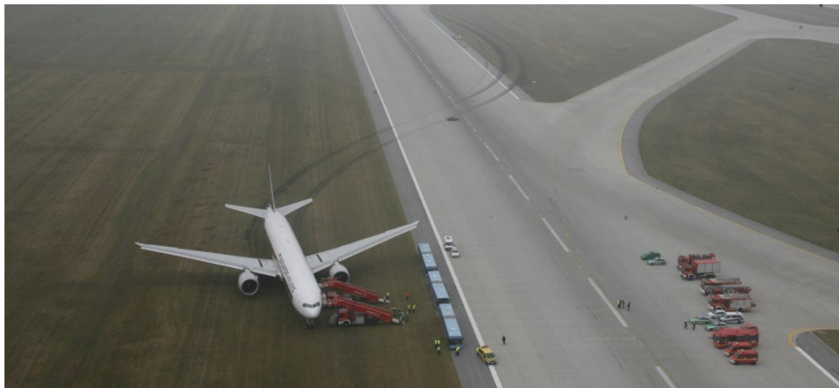
Fot. 1: Boeing 777 po zatrzymaniu poza pasem w wyniku lądowania automatycznego z zakłóceniami sygnału ILS. Źródło: Raport BFU.
