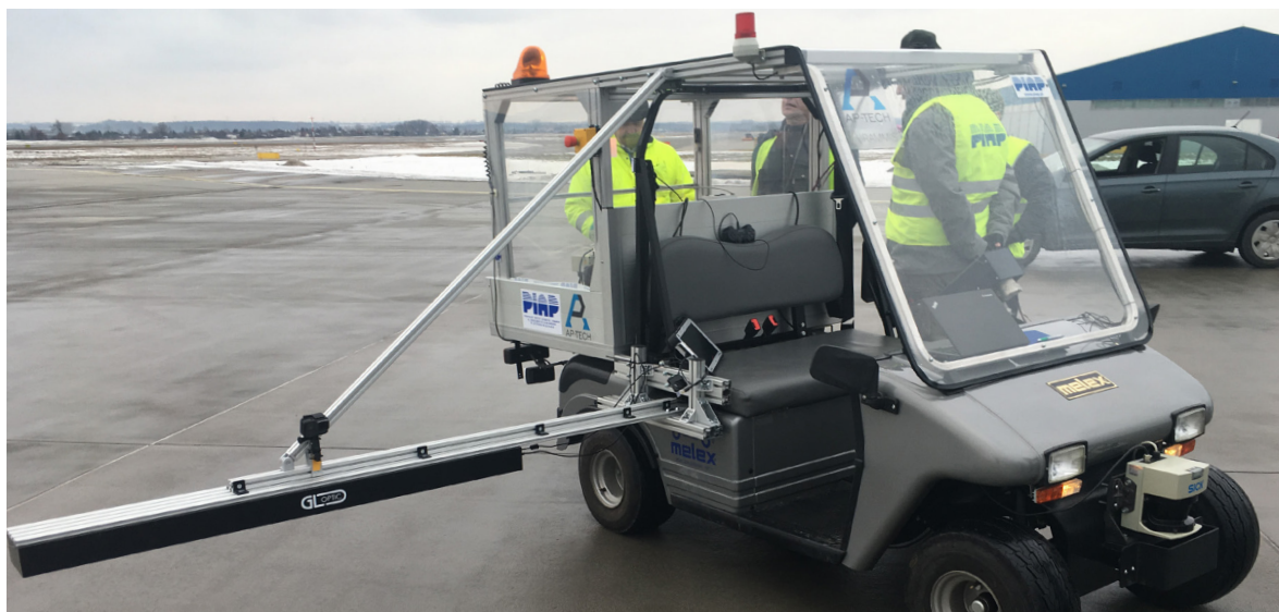
Fot. 1: Prototyp automatycznego systemu pomiarów AGL.
