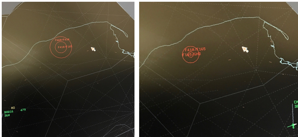
Fot. 2 i 3: Prezentacja wybranych dwóch (w zależności od wybranej wartości filtra ZONBLK) segmentów EP R 40 na SDD ACC EPWW. Fot.: autor
