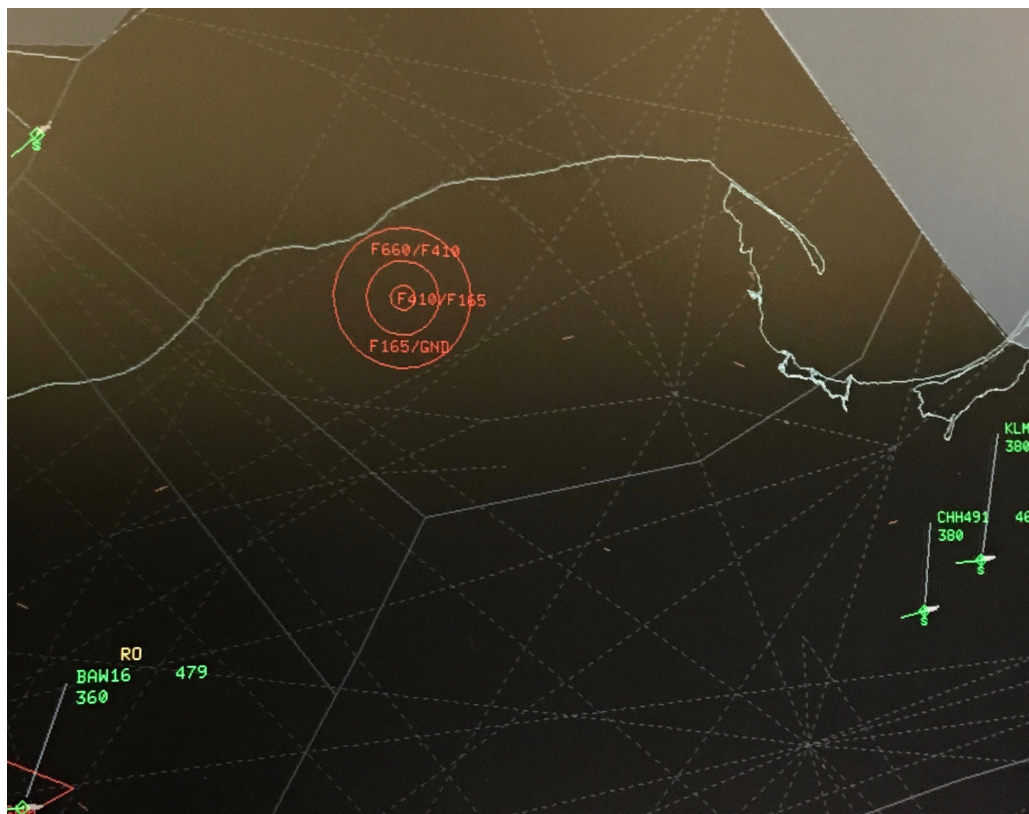
Fot. 1: Prezentacja wszystkich trzech segmentów EP R 40 na SDD ACC EPWW. Fot.: autor
