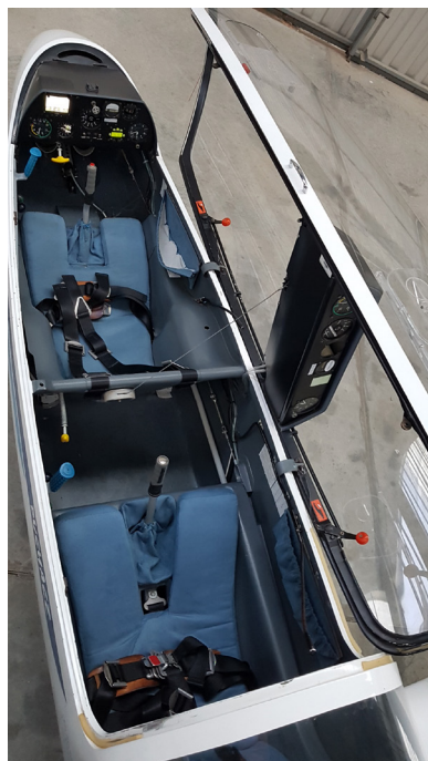
Fot. 3: Ergonomia kabiny szybowca SZD-50-3 „Puchacz”. Fot.: A Bulanda.
