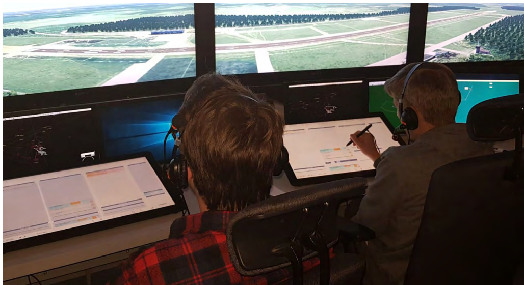
Fot. 4. Symulator EFES - proceduralna kontrola zbliżania na elektronicznych paskach postępu lotu, fot. PAŻP
