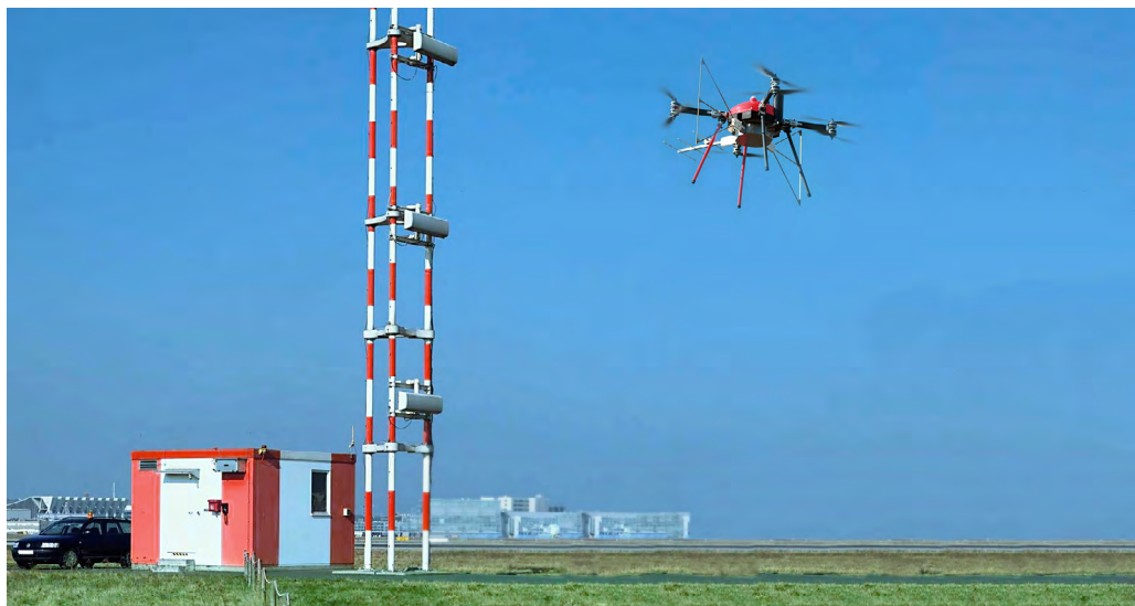
Pomiary ILS za pomocą drona, źródło: Colibrex
