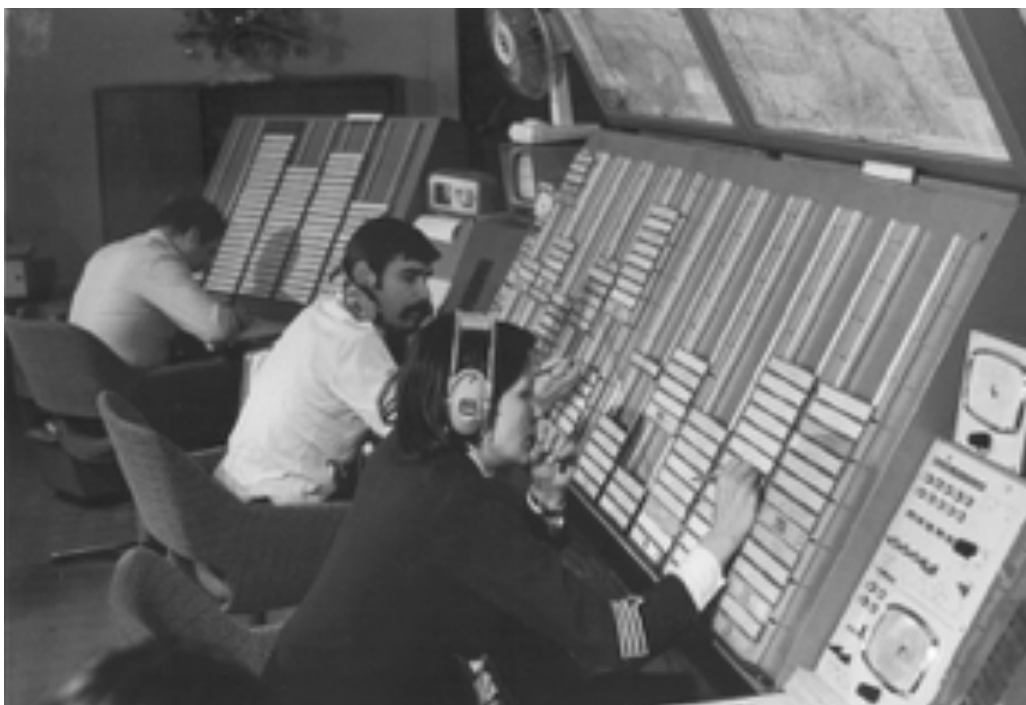
Fot. 2. Kontrola obszaru, lata osiemdziesiąte. Pierwsze stanowisko z lewej to stanowisko asystenta kontroli obszaru, sektor „Zachód”, w środku kontroler tego sektora (Józef S.) a także kontrolerka pełniąca dyżur na stanowisku ACC Sektor Wschód - Mirosława S.). Przed asystentem i kontrolerami widać tzw. „beje”, na których każdy lot był przedstawiany w postaci kilku pasków postępu lotu wsuniętych w specjalną plastikową ramkę zwaną holderem. Autor zdjęcia: NN.
