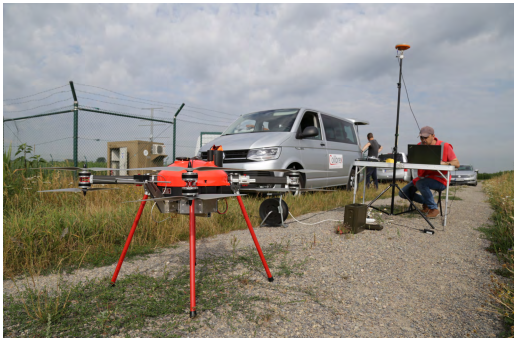
Wykonywanie pomiarów na lotnisku za pomocą drona, źródło: Colibrex
