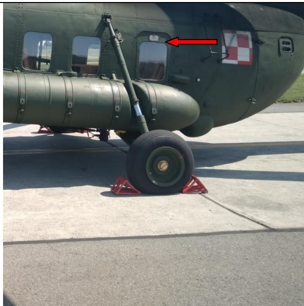
Wyjście ewakuacyjne lewa burta widok z zewnątrz. Wyrwać czerwony uchwyt i wyciągnąć okno.
