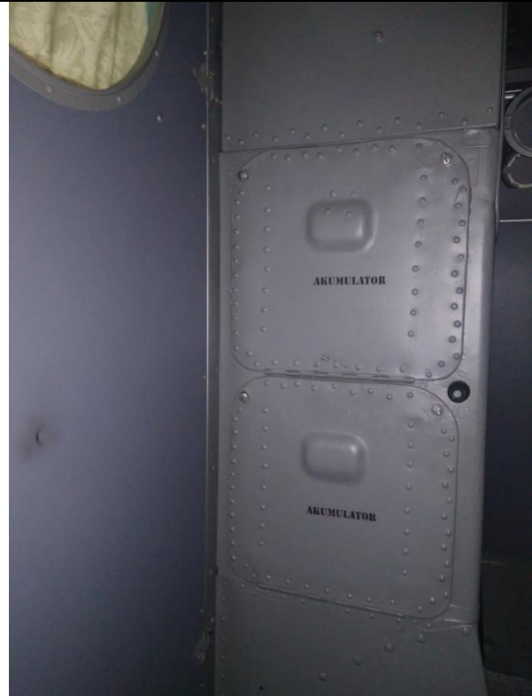
2 akumulatory w przedniej części prawej burty przy drzwiach kabiny załogi
