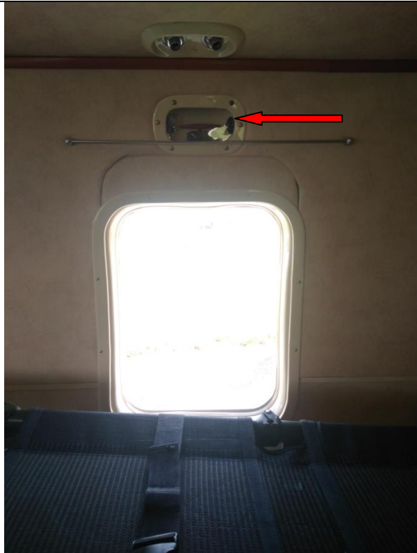
Wyjście ewakuacyjne prawa burta widok wewnątrz. Wyrwać czerwony uchwyt i wypchnąć okno.
