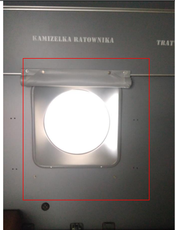
Wewnętrzny orientacyjny zarys wyjścia ewakuacyjnego na prawej burcie po zewnętrznej ingerencji ratowniczej.
