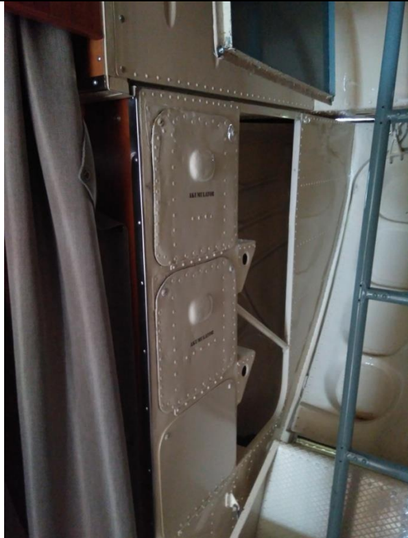
2 akumulatory tylna część prawej burty przy tylnych drzwiach
