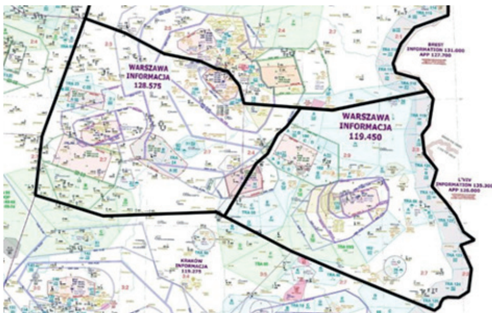
Rys. 1. Jedna z wielu zmian ocenianych w ostatnim czasie: nowy podział sektorowy FIS Okęcie. Zrozumienie, co jest zmianą dotyczącą systemu funkcjonalnego ATM/ANS determinuje wykonanie oceny bezpieczeństwa.
