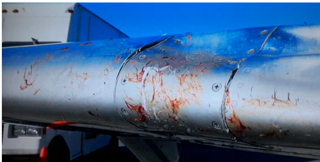
Fot. 5. Uszkodzenie samolotu w wyniku zderzenia z ptakami, autor: Paweł Szpakowski
