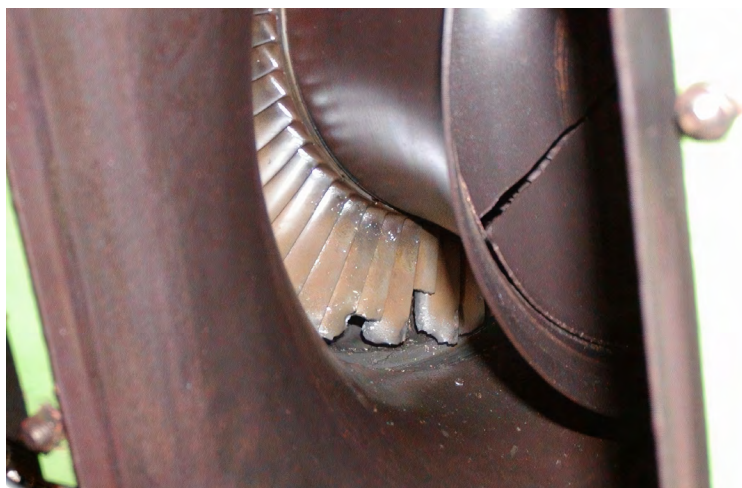
Fot. 4. Uszkodzenia silnika M601E samolotu SP-TPB - zdjęcie Waldemar Golacik
