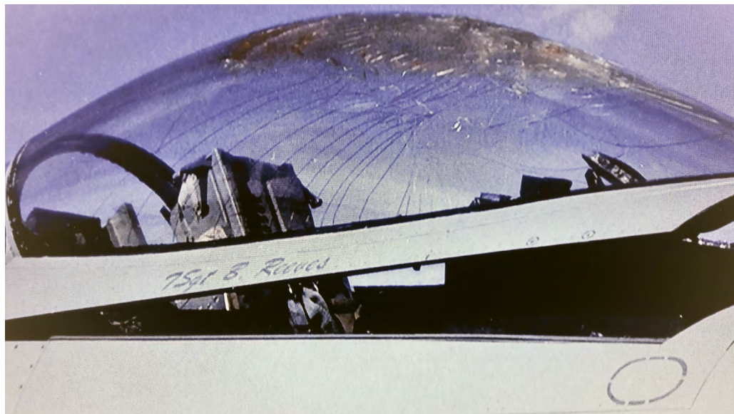
Fot. 5. Rozbita osłona kabiny pilota w wyniku zderzenia ze stadem ptaków, autor: Paweł Szpakowski
