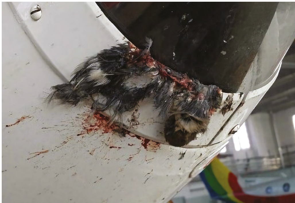
Fot. 6. Ślady po kolizji samolotu pomiarowego PAŻP z ptakiem, autor: Tomasz Lasocki
