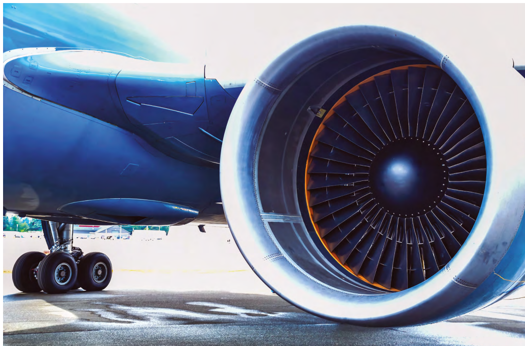
Fot. 2. Zassanie ptaków do wnętrza to jedna z przyczyn uszkodzenia silników odrzutowych, źródło: pixibay.com
