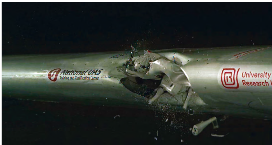
Fot. 3. Uszkodzenie skrzydła samolotu w wyniku zderzenia z dronem, źródło: ze zbiorów autora
