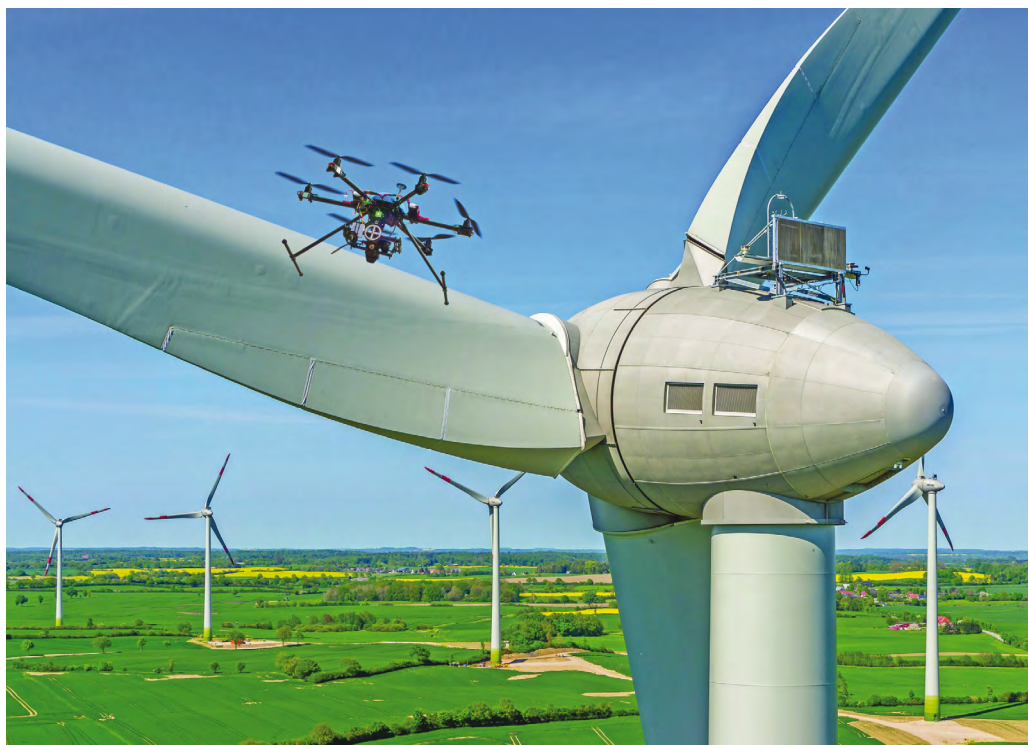
Fot. 6. Drony to obecnie powszechne narzędzie do oceny wpływu farm wiatrowych na infrastrukturę CNS, źródło: Wind Systems Magazine
