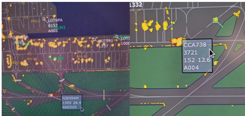
Ryc. 3. Zobrazowanie prezentowane na wskaźniku CWP systemu Saab A3000 oraz etykieta samolotu
