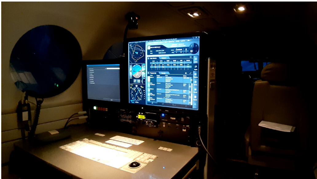
Ryc. 3. Miejsce pracy inspektora pokładowego, wykonującego nocną kontrolę z powietrza, źródło: Szymon Markiewicz
