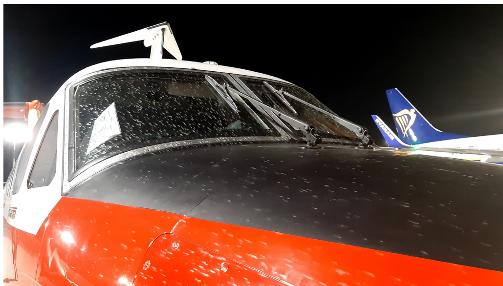
Fot.4. Zabrudzone przez owady szyby utrudniają prowadzenie obserwacji otoczenia samolotu, źródło: Szymon Markiewicz
