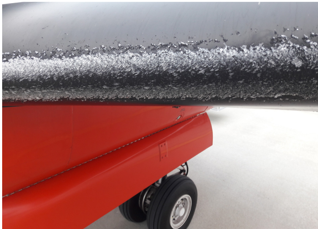
Fot.5. Oblodzenie statku powietrznego zagraża bezpieczeństwu lotu, źródło: ze zbiorów autora
