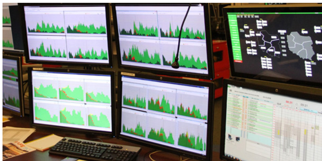
Rys. 3. Interfejs CHMI, obrazujący ilość ruchu lotniczego w poszczególnych sektorach. Źródło: fot. PAŻP [5]
