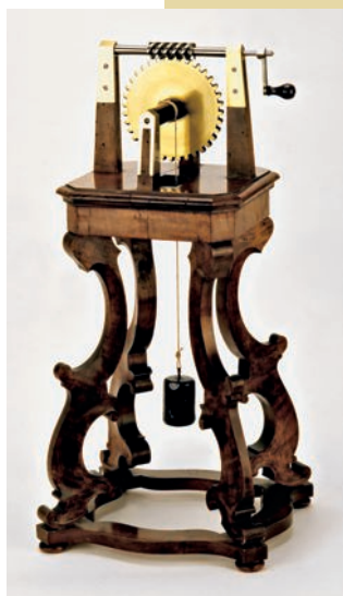
Fig. 1 Verricello con vite senza fine proveniente dal Conservatorio di Arti e Mestieri
