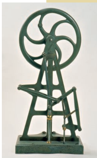
Fig. 4 Meccanismo dimostrativo per la trasformazione del moto circolare in moto rettilineo costruito nell'Officina dell'Istituto e presentato all'Esposizione Universale di Parigi del 1867
