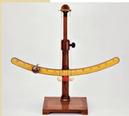
Fig. 2 Strumento didattico per lo studio degli urti elastici. Di costruzione francese, risale a circa il 1860
