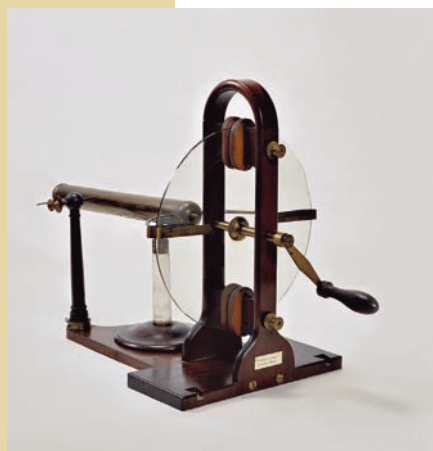
Fig. 9 Macchina elettrostatica della fine del Settecento firmata da Jesse Ramsden
