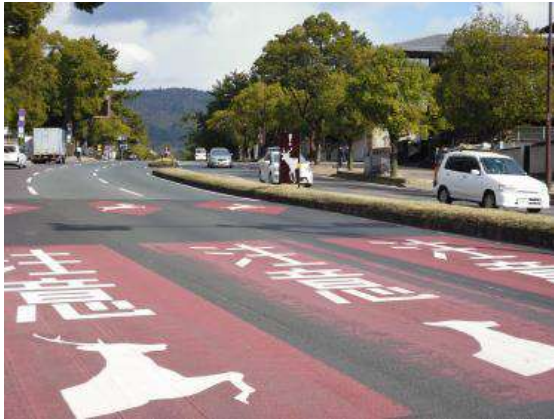
路面標示による注意喚起
