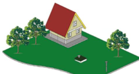
ОТВЕДЕНИЕ ОЧИЩЕННОЙ ВОДЫ С ПОМОЩЬЮ ПРОМЕЖУТОЧНОГО КОЛОДЦА
