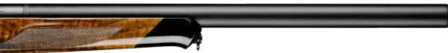
Die durchgehend stufenlose Lauf-Schalldämpfer-Kombination verteilt das Gewicht des Schalldämpfers auf die gesamte Länge und sorgt damit für weniger Kopflastigkeit als bei einem Over- oder On-Barrel-Schalldämpfer. Diese Art der Konstruktion verspricht dem Jäger nicht nur absolute Führigkeit, sondern auch ein besseres Schwingungsverhalten – gerade beim Schuss auf bewegliche Ziele.
