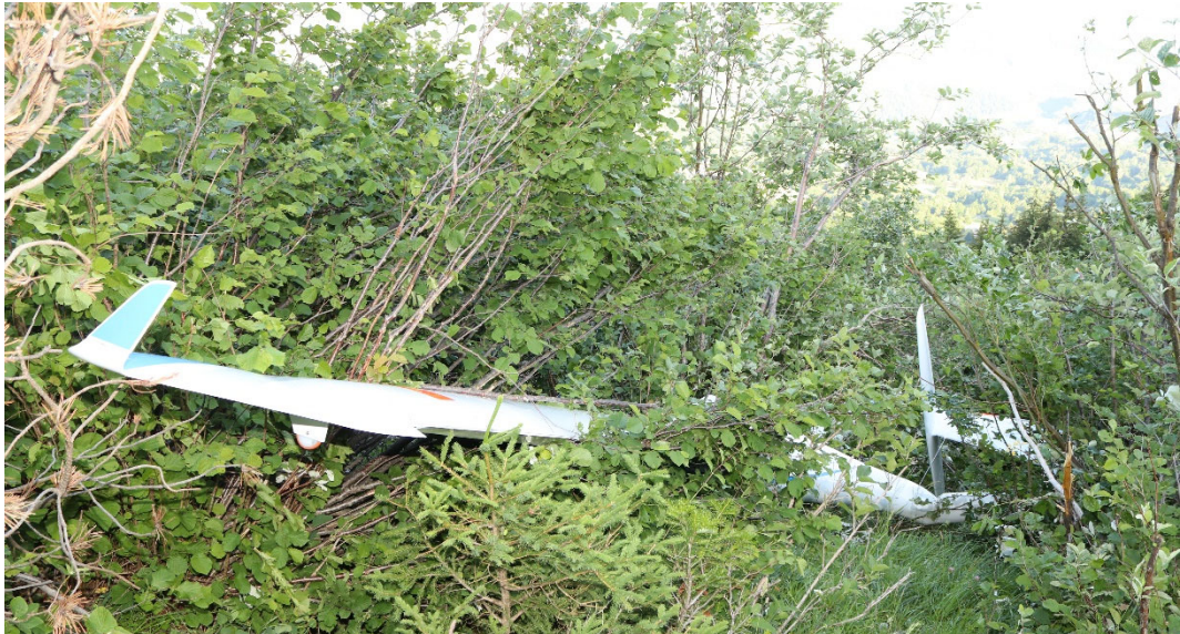
Abbildung 2: Wrack der D-MANS, wie es sich den auf der Unfallstelle eintreffenden Einsatzkräften präsentierte. Es ist nicht erkennbar, dass eine Stromschlaggefahr bestand und kein Gesamtrettungssystem verbaut war (Foto der Kantonspolizei Wallis).
