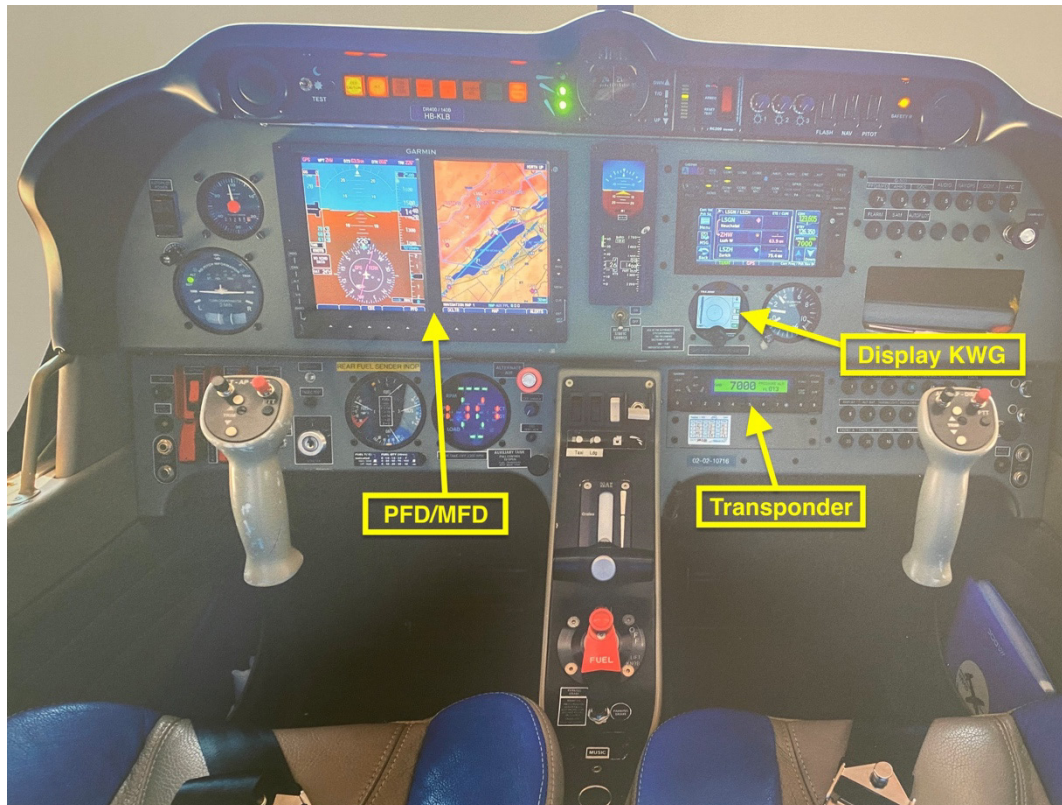
Abbildung 4: Instrumentenpanel der HB-KLB mit dem kombinierten PFD/MFD, dem Display des Kollisionswarngeräts (KWG) und dem Transponder (Quelle: GVMN). Der Schalter für das Kollisionswarngerät befindet sich links neben dem Zündschloss (auf der Abbildung durch den Steuerknüppel verdeckt).
