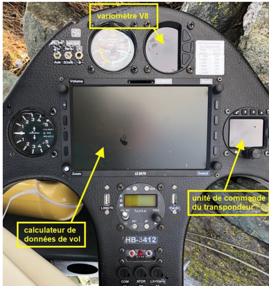
Figure 5 : Panneau d'instruments du HB-3412 avec le calculateur de données de vol, le variomètre V8 et l'unité de commande du transpondeur. Photo prise le lendemain sur le lieu de l'accident.
