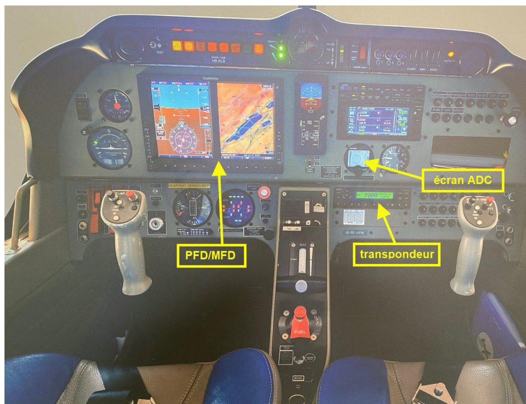
Figure 4 : Panneau d'instruments du HB-KLB avec le PFD/MFD combiné, l'écran de l'avertisseur de collision (ADC) et le transpondeur (source : GVMN). L'interrupteur du système d'alerte anticollision se trouve à gauche du contacteur d'allumage (masqué par le levier de commande sur la figure).
