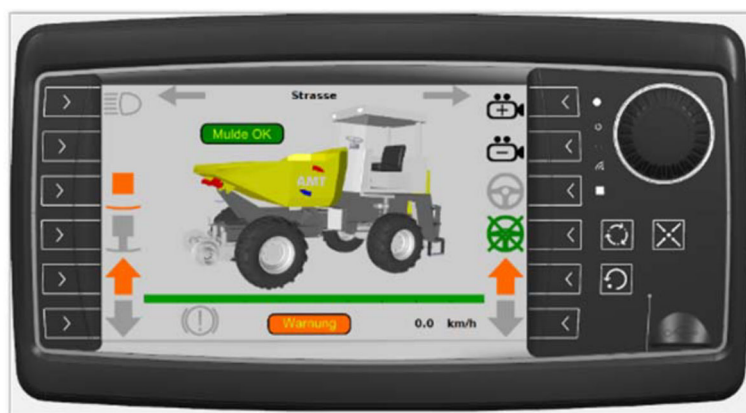
Abbildung 8: Bedienbildschirm für das Ausgleisen (umschalten in den Strassenmodus).
