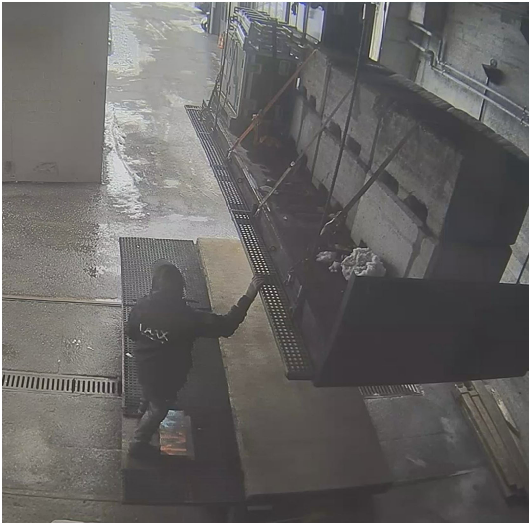
Abbildung 8: Standbild aus der Aufzeichnung der Überwachungskamera in der Talstation. Das Bild zeigt die beladene Unterlastbarelle während des Anhängvorgangs an die Seilbahnkabine 2.
