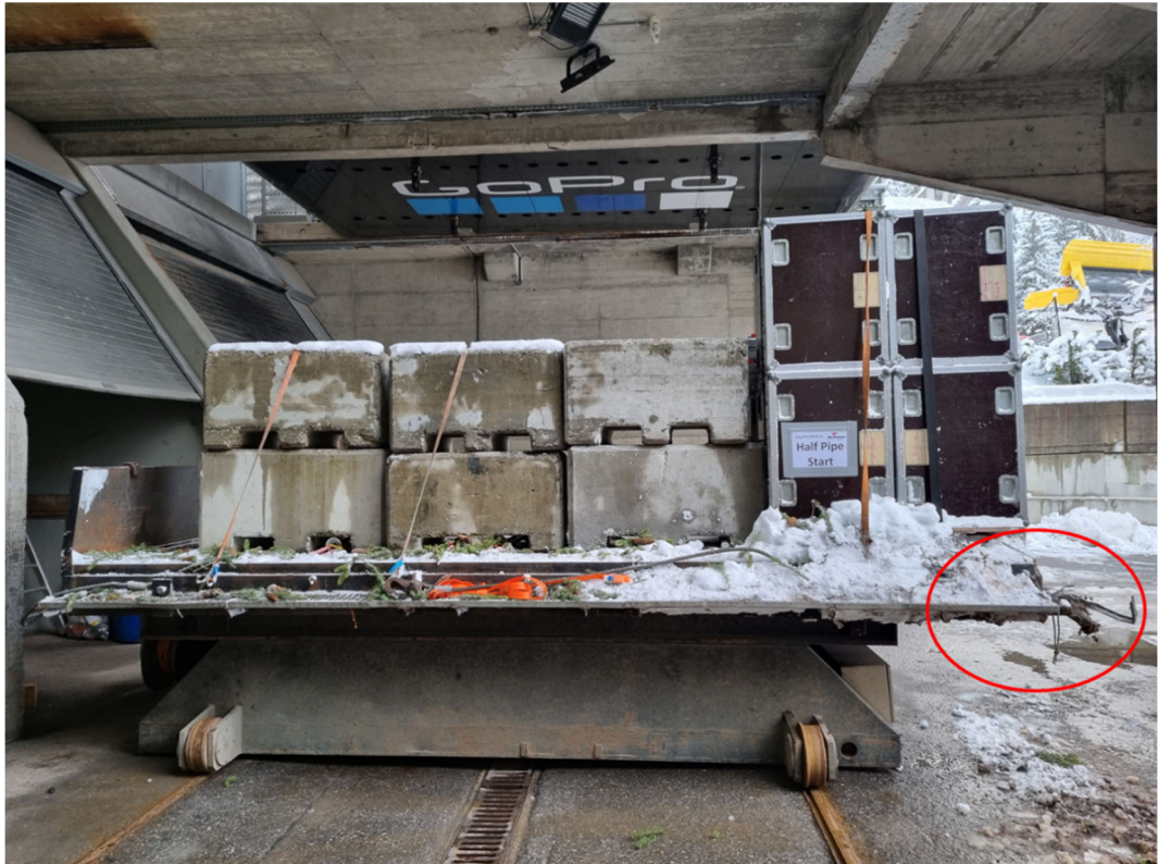
Abbildung 5: Beladene, leicht beschädigte Unterlastbarelle nach der Rückfahrt in die Talstation. Quelle: BFL, bearbeitet durch die SUST.
