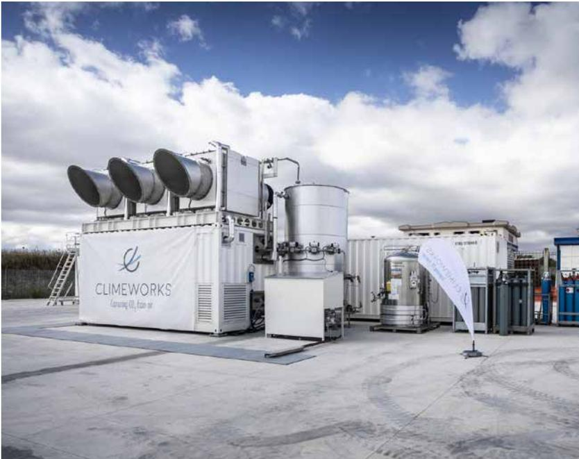
Climeworks, una empresa con sede en Suiza, ha sido la primera en el mundo en desarrollar una tecnología comercial de captura directa de aire que permite eliminar el dióxido de carbono del aire. Los colectores tienen el tamaño de un automóvil pequeño y pueden apilarse para crear una planta de tamaño variable.
