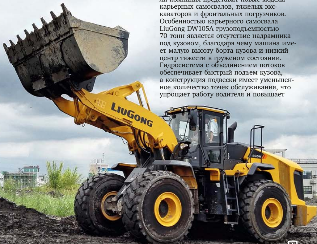
□ Фронтальный погрузчик LiuGong 890H грузоподъемностью 9 тонн оборудован двигателем Cummins, трансмиссией и мостами ZF.
