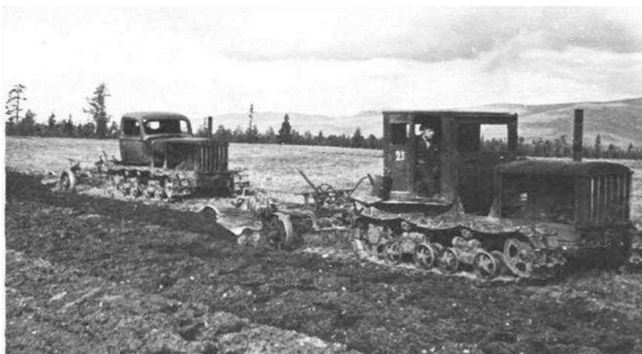
Трактор, предназначенный для обработки болотных почв. 1949 г. ГОКУ ГАМО в г. Кировске. Ф. Р-179. Оп. 12. Д. 777.
