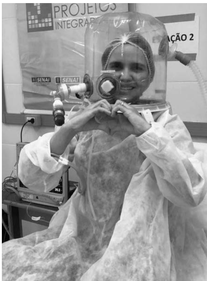
Figura 1. Fisioterapeuta utilizando em laboratório um protótipo de sistema tipo capacete desenvolvido especificamente para o enfrentamento a COVID-19. O elmo ( helmet ) permite a aplicação de pressão positiva ao redor da cabeça por meio de uma mistura de altos fluxos de ar comprimido e de oxigênio, possibilitando uma FiO_2 de até 100% e uma pressão positiva contínua de vias aéreas de até 18-20 cmH_2O , ao mesmo tempo que minimiza o risco de escape aéreo para o ambiente. Foto: arquivo pessoal de Holanda MA.
