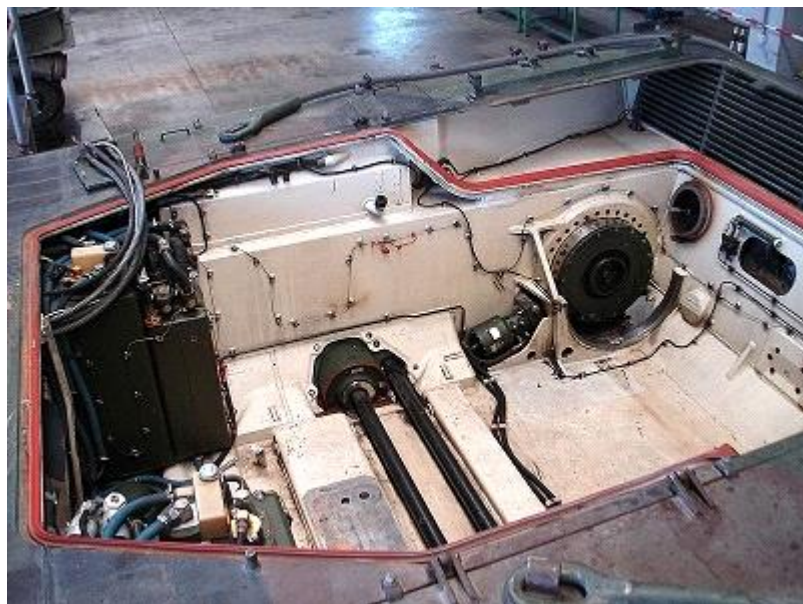
Leopard 2A5 torziós rúdjai a motortér aljában. Hét ilyen rúdpár tartozik a hét keréksorhoz.
