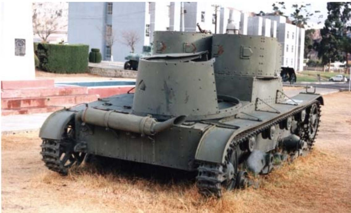
La característica torre troncocónica del tanque Vickers Mk E Type B sobre el compartimiento motor del que se encuentra en el Colegio Militar en La Paz. Carece del mantelete y cañón.
