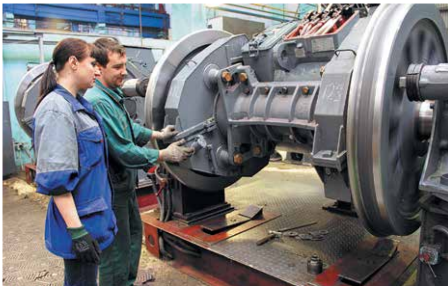
Стендовые испытания и регулировка КМБ с МОП качения
