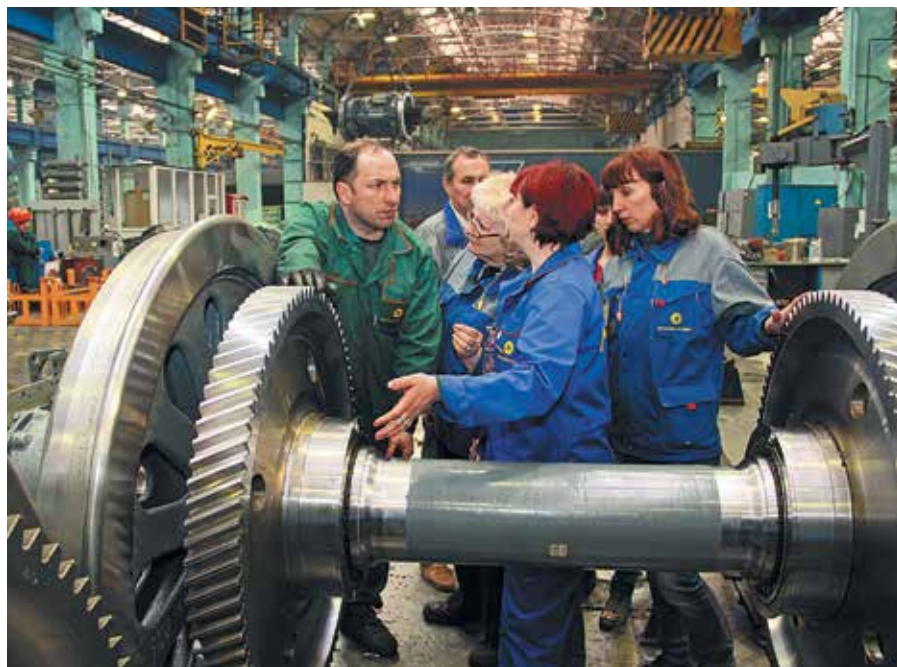
Испытание колесно-моторного блока
