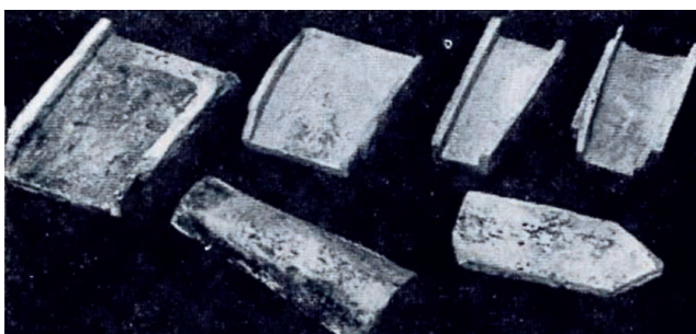
Рис. 5. Виды черепицы, обнаруженной при реставрации Архангельского собора Московского Кремля (по: Меркелова В.Н. К реконструкции фасадов...).
