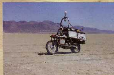
На испытаниях в пустыне робот-мотоцикл Ghost Rider самостоятельно проехал 32 км.
