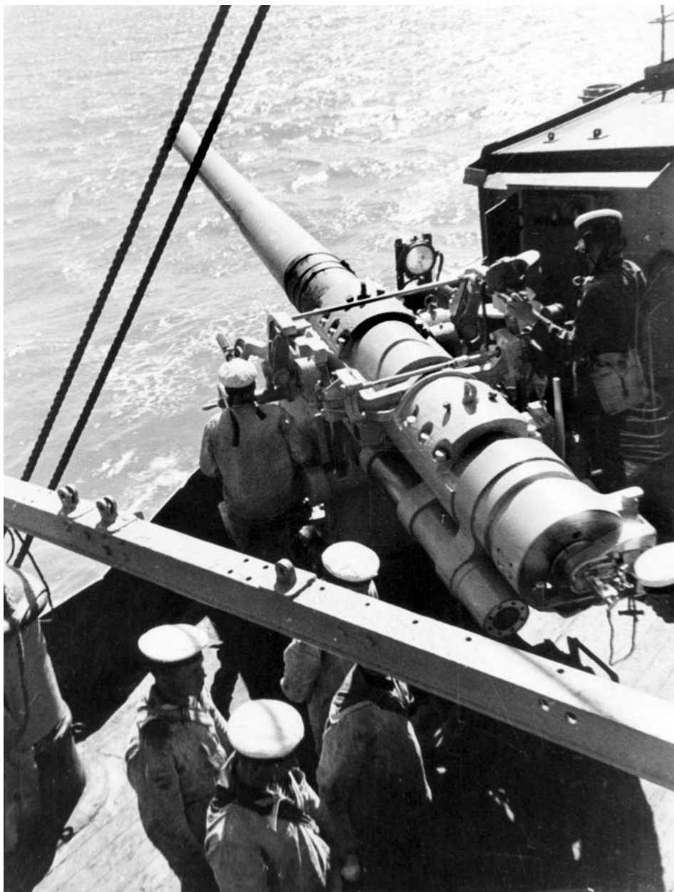
Главный калибр «Коминтерна» – 130-мм/55 орудие Обуховского завода образца 1913 г. (палубная установка №4 левого борта)
