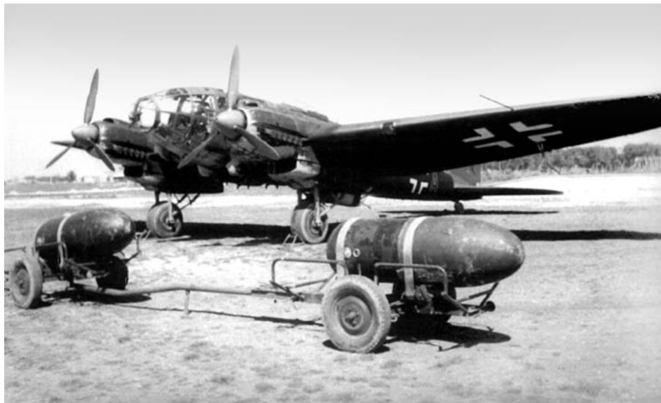
Бомбардировщик He-111 из состава I/KG28 готовится к вылету на минную постановку. На переднем плане тележки с минами LMA
