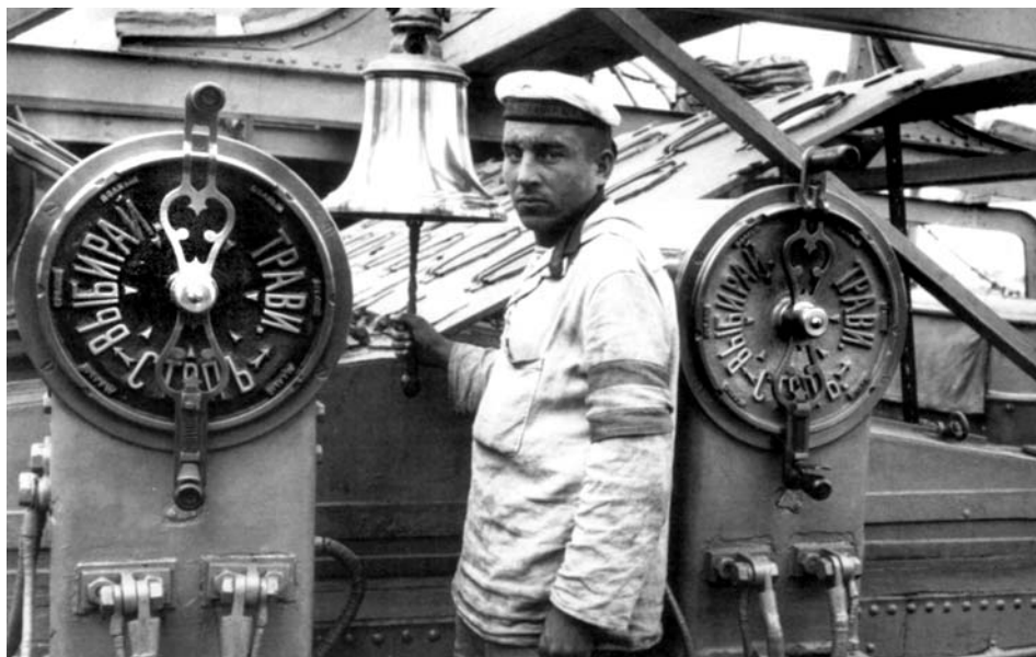
В е р х у : краснофлотец у рынды на шкафуте корабля, 1930 г. Хорошо видны манипуляторы управления паровыми лебедками
