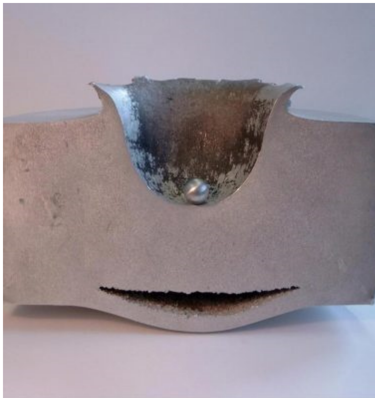
Výsledek nárazu 12 mm hliníkového projektilu o průměrné rychlosti na oběžné dráze (7 km/s) do 13 cm silného hliníkového plátu. Zdroj ESA.
