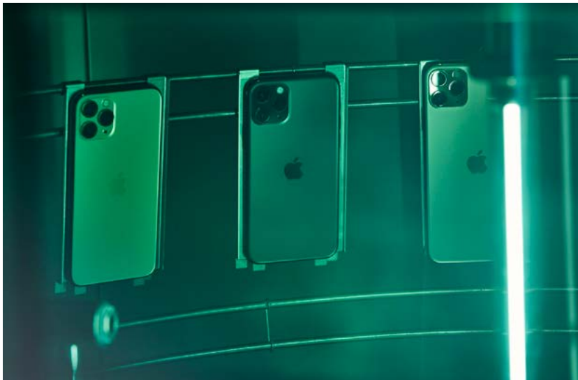
上图：太阳光照测试可模拟并加速产品在窗边或阳光下使用时接受的紫外线辐射。
