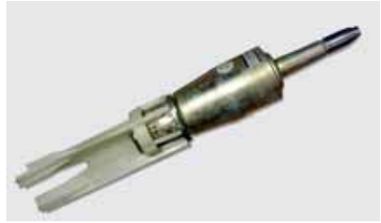
10 الذخيرة الفرعية الأميركية المضادّة للدروع من طراز "Mk 118" "Rockeye"
