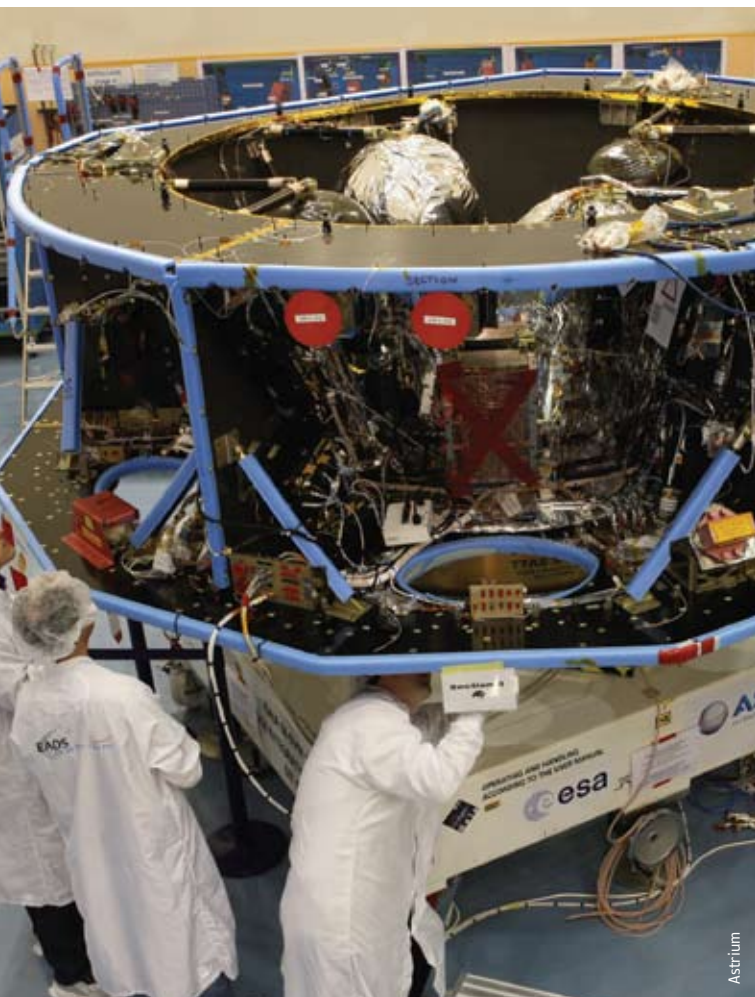
Zusammenbau des Versorgungsmoduls
