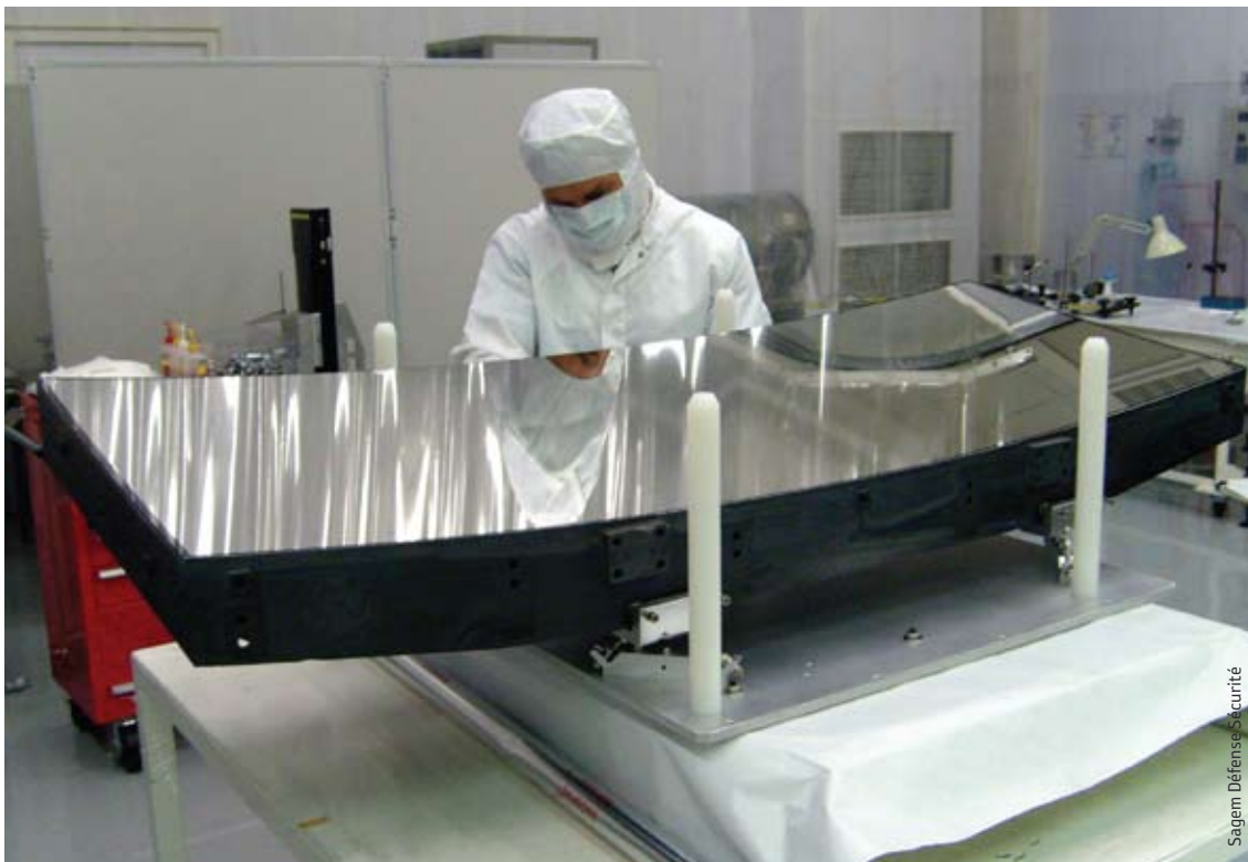
Endkontrolle eines der beiden Hauptspiegel von Gaia
