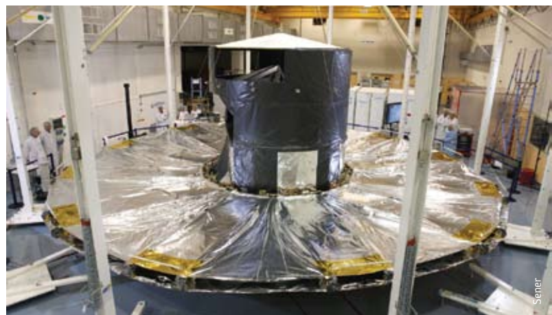
Das Raumfahrzeug nach der Entfaltung des Sonnenschutzschirmes im Reinraum
