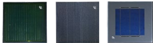
v.l.n.r.: Mustermodule mit CIGS-Technologie von Sunplugged, mit CZTS-Technologie von crystalsol und mit kristalliner SI-Technologie, gefertigt bei ertex Solartechnik, Fotos: OFI
