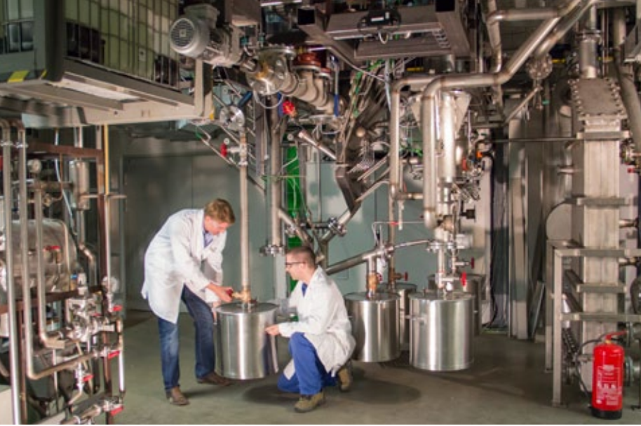
Unterer Teil der Forschungsanlage ohne thermische Isolierung, Foto: TU Wien
