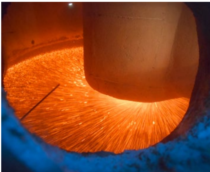
oben: Granulationsprozess links: Trockengranulat Fotos: Primetals Technologies
