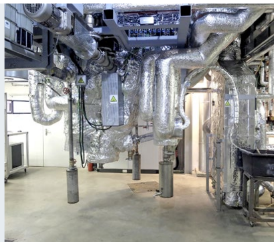
Wirtelschicht-Versuchsanlage für Chemical Looping Combustion und Biomassevergasung, Foto: TU Wien, Institut für Chemische Verfahrenstechnik und Energietechnik
