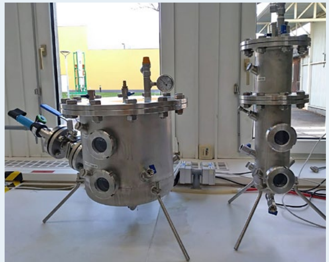
Rieselbettreaktor und CSTR (Continuous stirred-tank reactor) im Kleinmaßstab, Foto: Universität für Bodenkultur Wien, Institut für Umweltbiotechnologie
