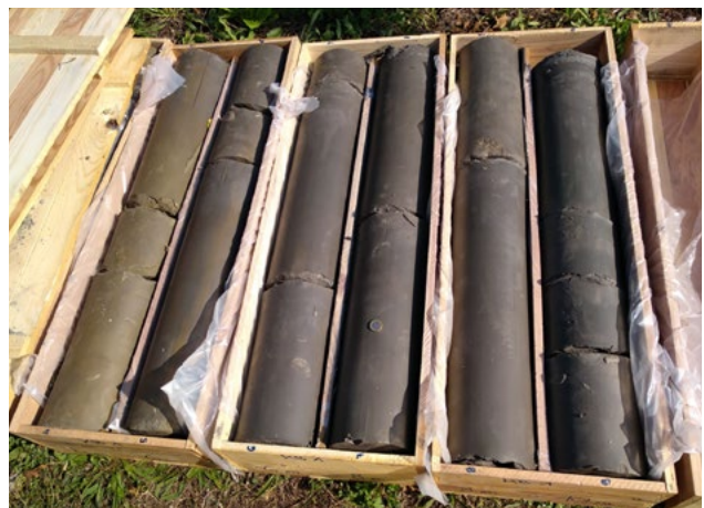
Die gesamte Bohrtiefe kann durch dunkelgraues, feinkörniges, toniges bis schluffiges Material charakterisiert und der Mergelfolge des Badener Tegel im Wiener Becken zugeordnet werden. Hier ein Teil der gewonnenen Bohrkern aus der 30 m-Kernbohrung, Foto: Projekt SANBA
