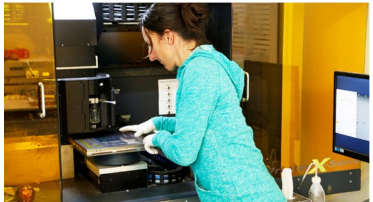
Serielle Verschaltung von Dünnschicht-Solarzellen mittels Inkjet-Materialdruck, Foto: Sunplugged
