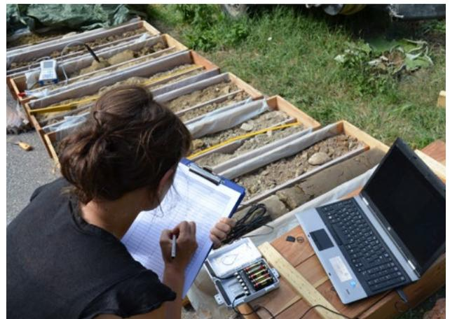
Wärmeleitfähigkeitsmessungen am Bohrkern, Foto: Heat Harvest-Konsortium
