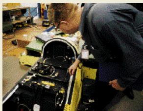
VIDEOPLATTFORM. På den svarta, fjädermonterade plattformen strax bakom piloten monteras den videobandsspelare som ska spela in hela flygningen. Den måste sitta fjäderupphängd, för ingen video klarar plannets skakningar när kanonen avfyras.
