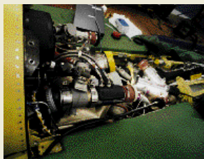
KLIMATKONTROLL. Det röda tarmpaketet är luftkonditioneringen som ger kylning är datorsystemen och håller klimatet åt piloten.
