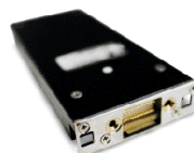
DATASTAV. Data till och från Gripen transporteras i en datastav. Det är en aluminiumskåp full med halvledarminne som pluggas direkt in på nätverket i planet. Staven kan laddas med färdplan eller ny mjukvara.
